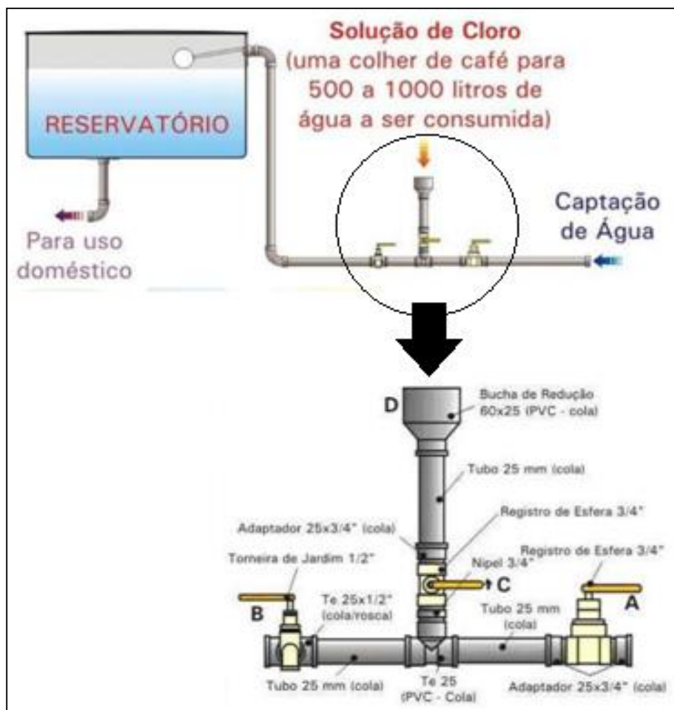
Figura 3 - Esquema do sistema de cloração desenvolvido pela Embrapa
