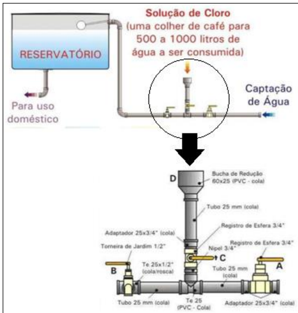
Figura 5 - Esquema do sistema de cloração desenvolvido pela Embrapa
