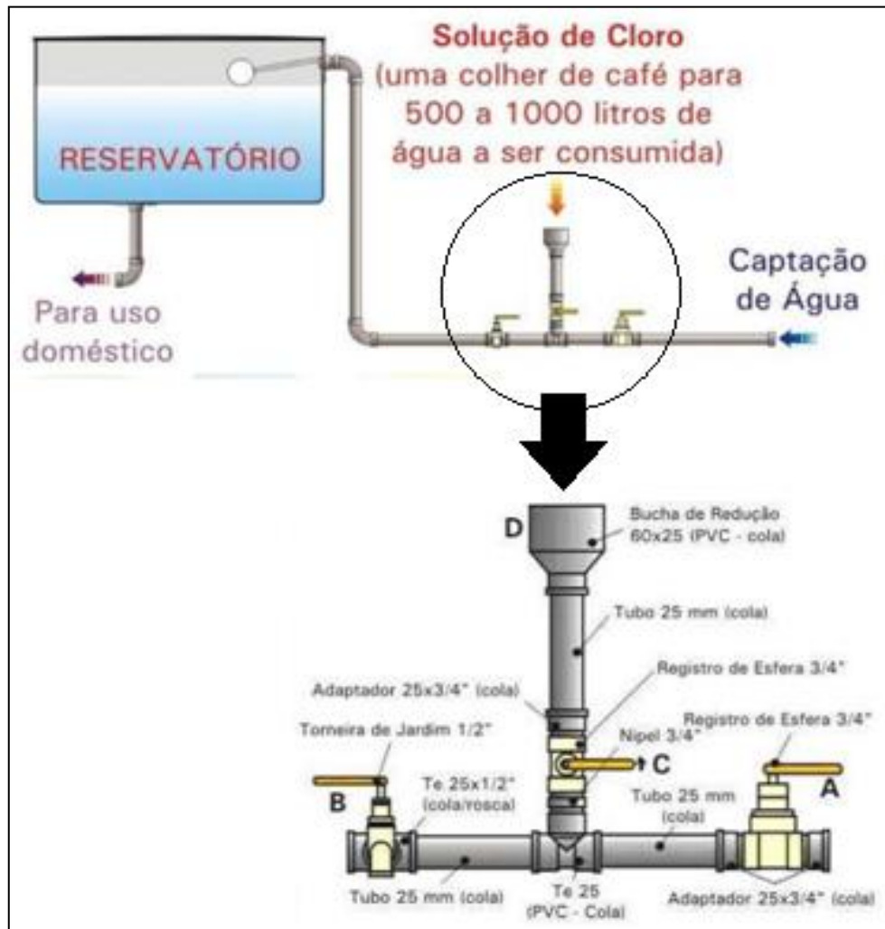
Figura 9 - Esquema do sistema de cloração desenvolvido pela Embrapa
