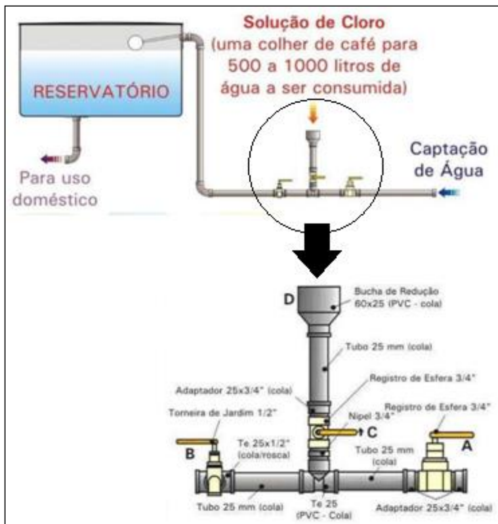
Figura 20 - Esquema do sistema de cloração desenvolvido pela Embrapa
