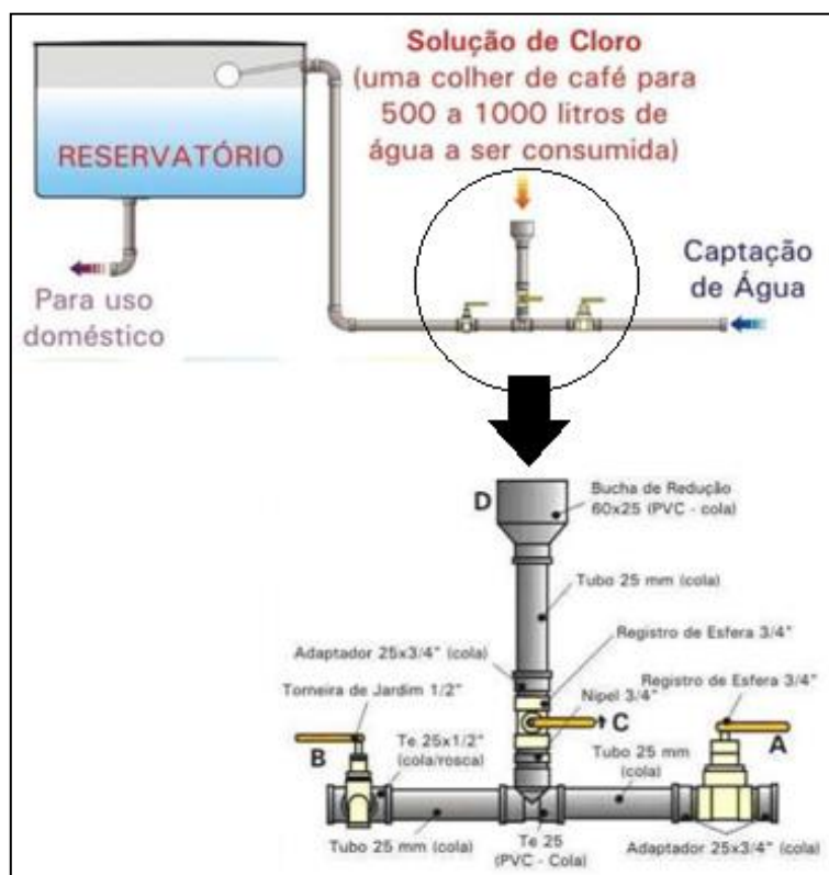
Figura 40 - Esquema do sistema de cloração desenvolvido pela Embrapa
