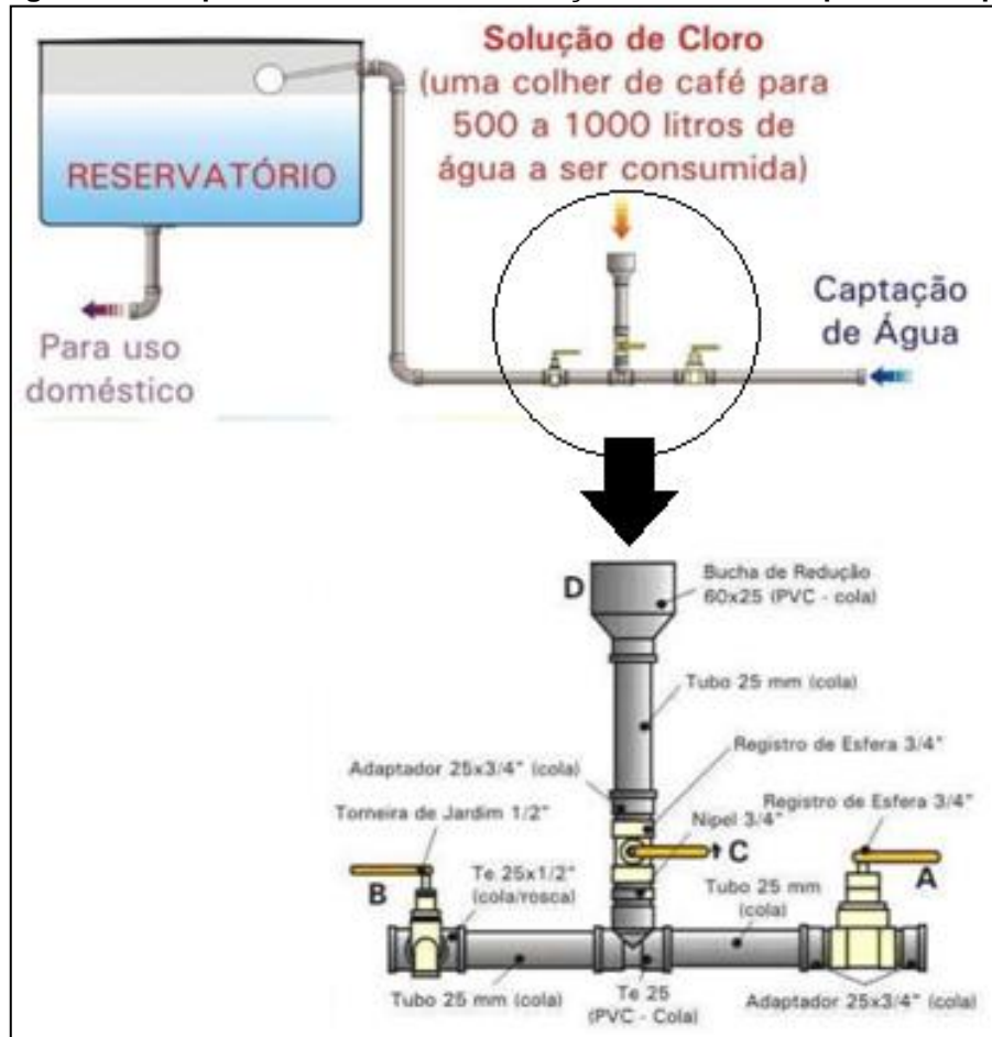
Figura 12 - Esquema do sistema de cloração desenvolvido pela Embrapa
