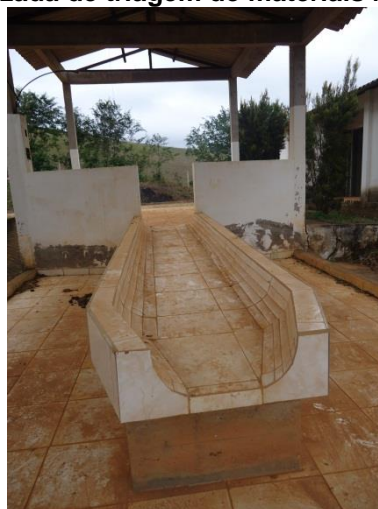
Figura 60 - Esteira não mecanizada de triagem de materiais recicláveis da UTC de Araponga
