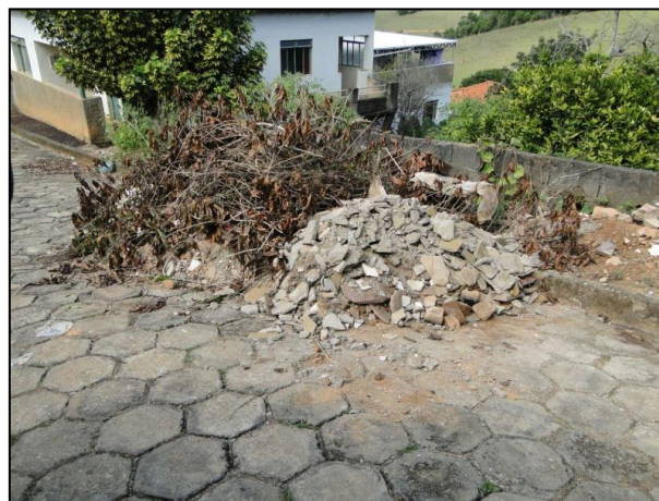
Figura 51 - Local inadequado de descarte de Resíduos de Construção Civil
