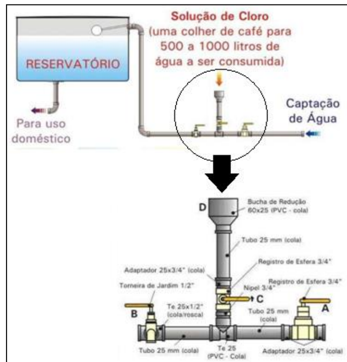
Figura 7 - Esquema do sistema de cloração desenvolvido pela Embrapa
