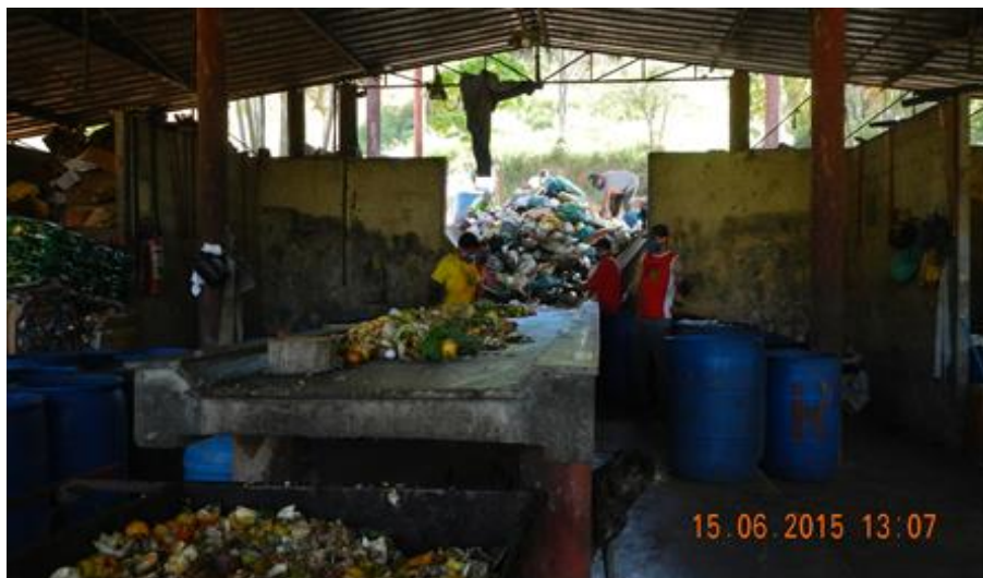
Figura 57 - Mesa de triagem de resíduos sólidos urbanos
