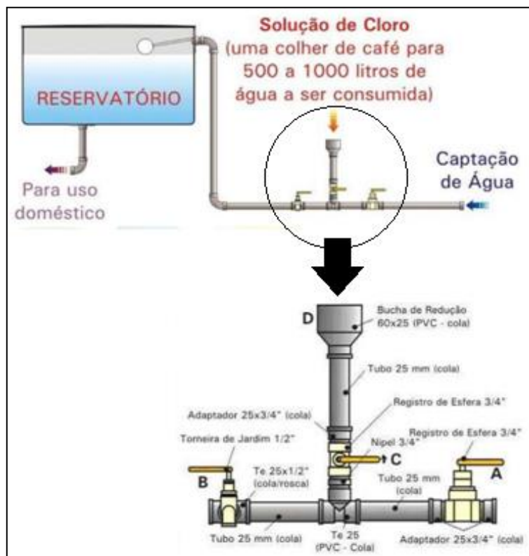
Figura 10 - Esquema do sistema de cloração desenvolvido pela Embrapa
