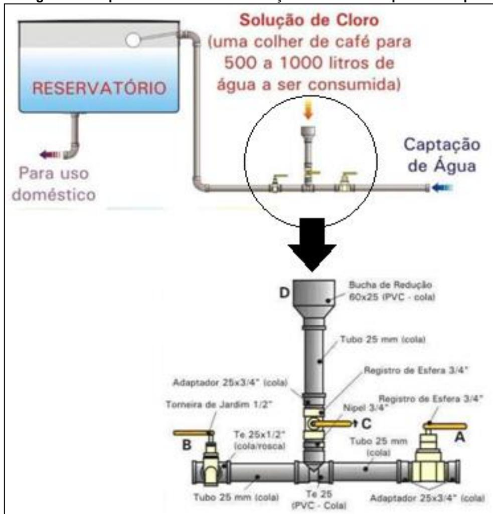
Quanto ao abastecimento realizado por captação em poços, a EMATER-MG recomenda que sejam feitas a limpeza e a desinfecção dos poços, assim como a cloração da água captada antes do consumo.
