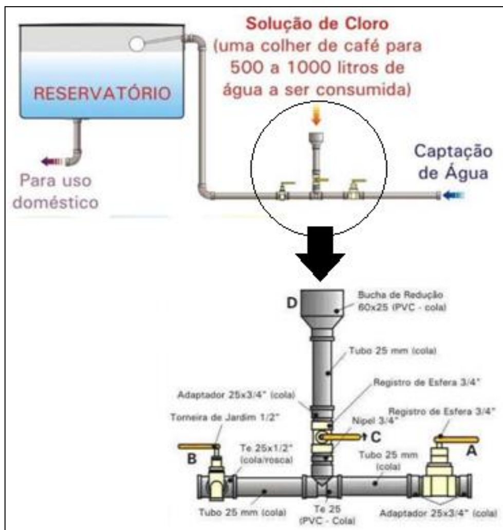
Figura 1 - Esquema do sistema de cloração desenvolvido pela Embrapa
