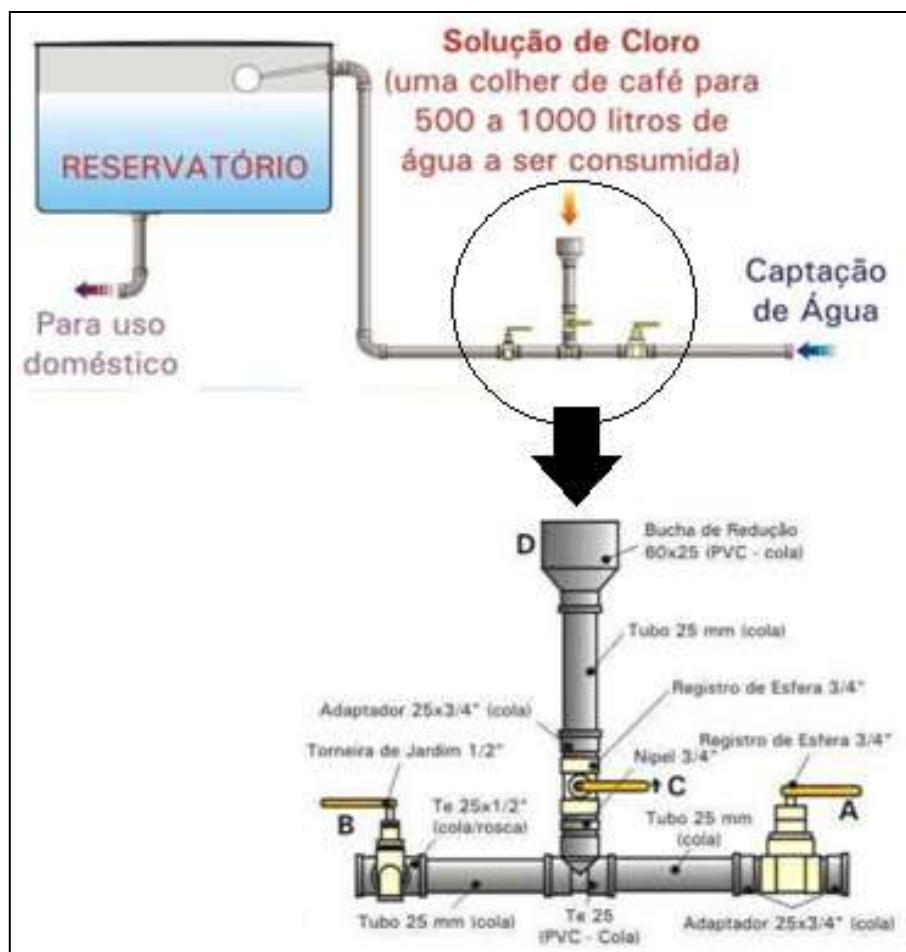
Figura 2 - Esquema do sistema de cloração desenvolvido pela Embrapa
