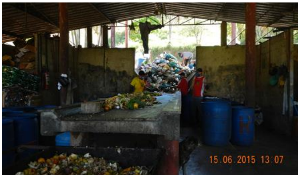
Figura 66 - Mesa de triagem de resíduos sólidos urbanos
