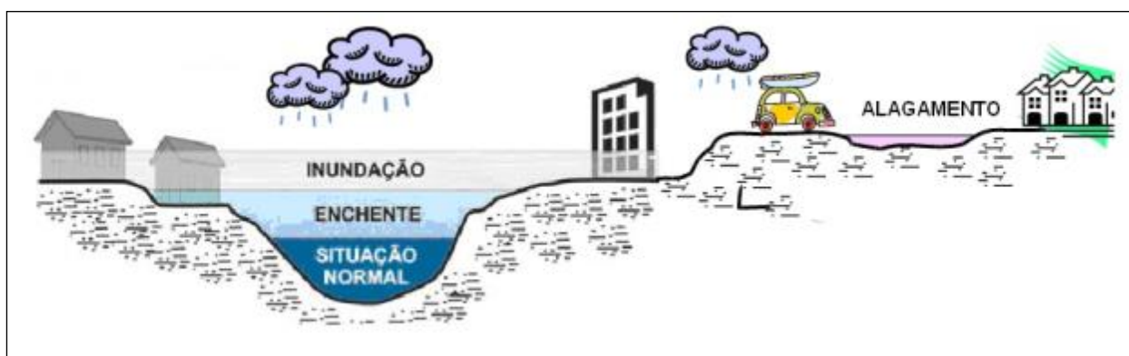
Figura 71 - Esquema ilustrativo sobre enchente, inundação e alagamento
