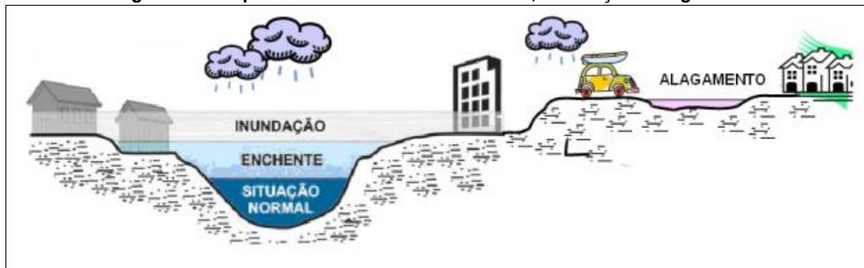
Figura 71 - Esquema ilustrativo sobre enchente, inundação e alagamento
