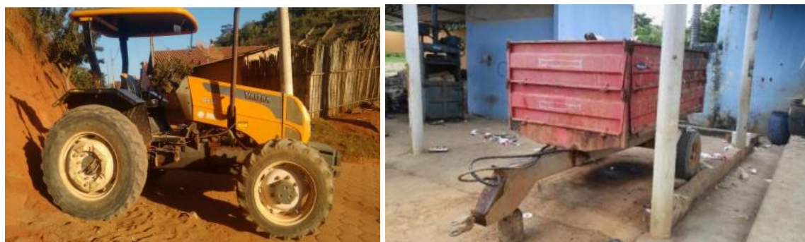
Figura 84 - Trator e caçamba para transporte dos rejeitos ao aterro controlado
