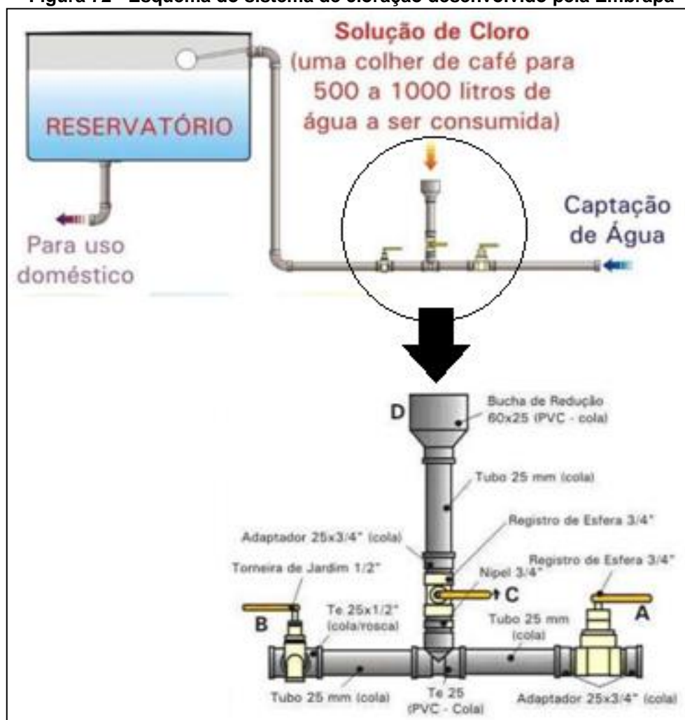
Figura 72 - Esquema do sistema de cloração desenvolvido pela Embrapa
