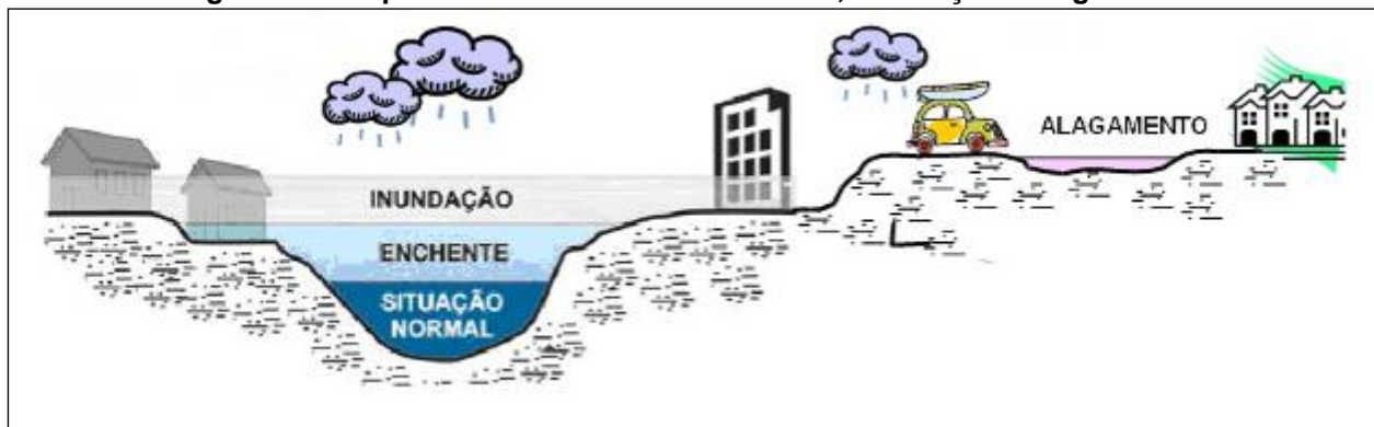
Figura 54 - Esquema ilustrativo sobre enchente, inundação e alagamento
