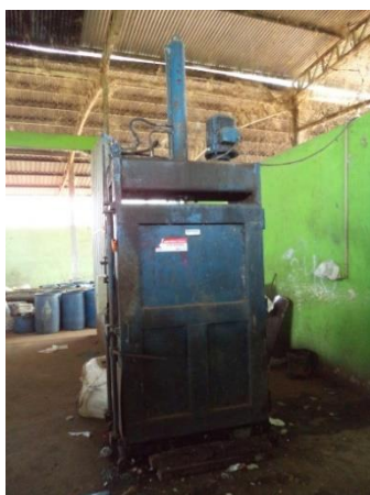
FIGURA 9 - PRENSA PARA COMPACTAÇÃO DOS REICLÁVEIS (FONTE: ACERVO DO AUTOR, 2014)
